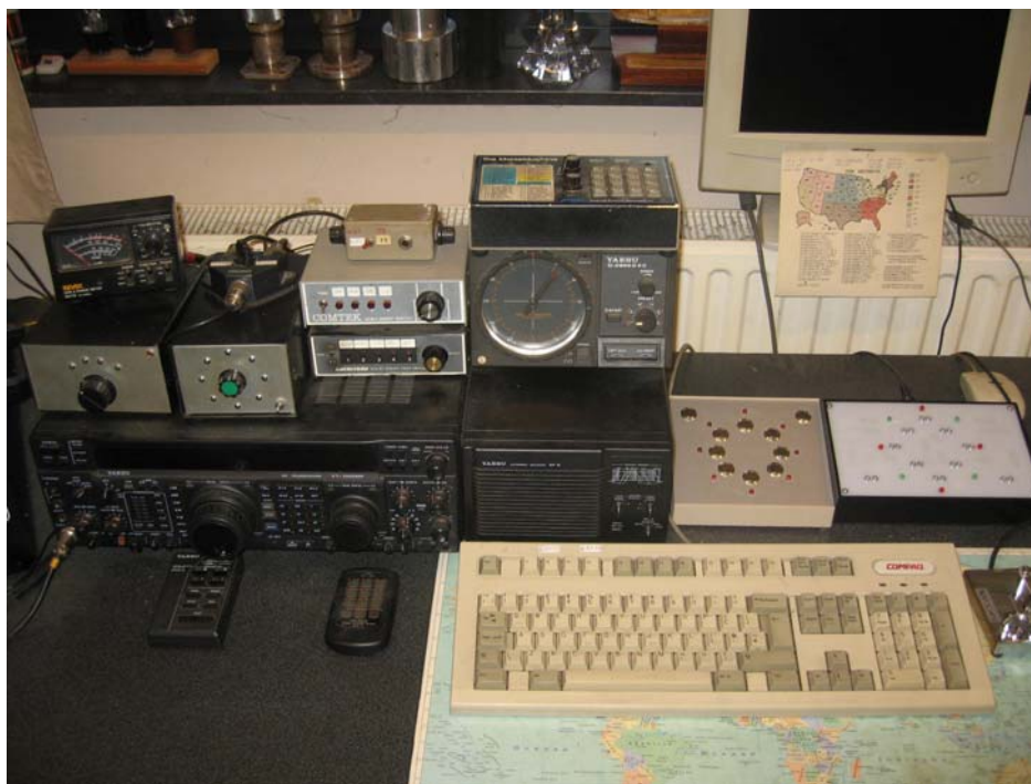
Figuur 9. De oude bediening met draaischakelaar en groene knop staat bovenop de transceiver. Bovenaan rechts op de foto de bediening met drukknoppen en die met aanraakschakelaars.
