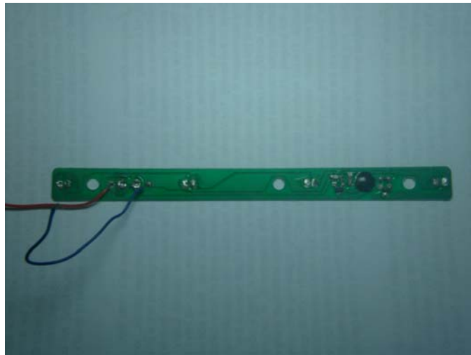
Figuur 6. Het printje uit de verlichtingsmodule.
